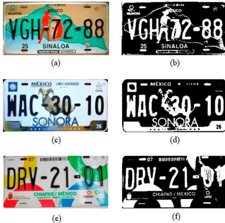
**Figura 1.2.** Resultados de matrículas mexicanas procesadas con el método de Otsu (1979). Imágenes originales (a), (c) y (e); (b), (d) y (f) imágenes binarias obtenidas.
