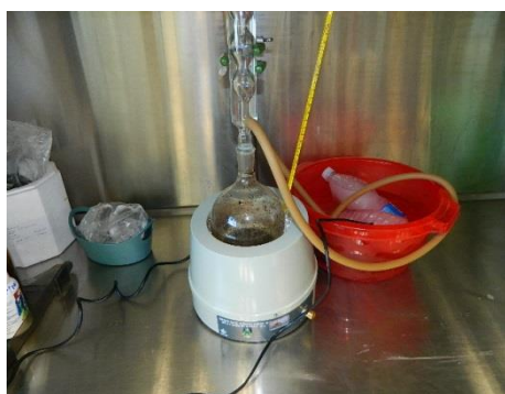
Fig. 1. Sistema de reflujo: manta eléctrica a temperatura de 80^{\circ}\text{C} para la obtención del extracto de las algas en estudio.
