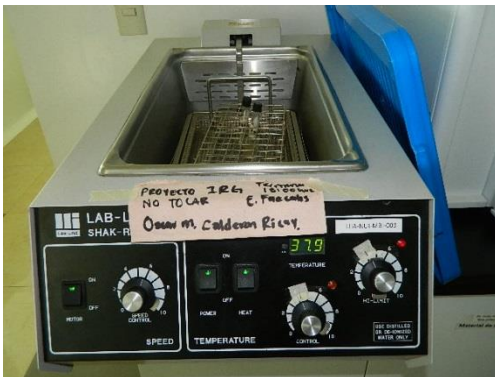
Fig 3. Estufa eléctrica: inoculación de caldo de TSB inoculado con la bacteria E. faecalis a 37°C.
