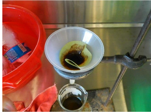
Ilustración 3 Fig.5 Filtración del extracto obtenido, con papel Whatman # 3
