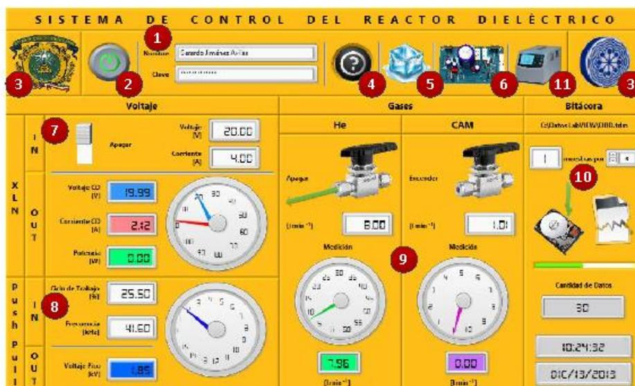
Figura 4. Panel principal de la interfaz gráfica de usuario para control del reactor C-DBD<sub>2</sub>.
