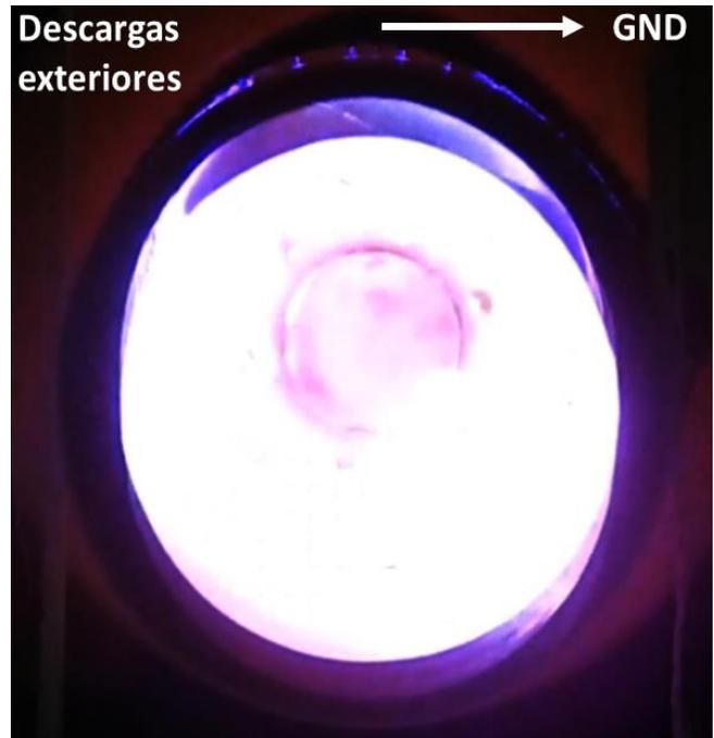
Figura 4.10. Pérdidas de potencia por la formación de microdescargas fuera del reactor.
