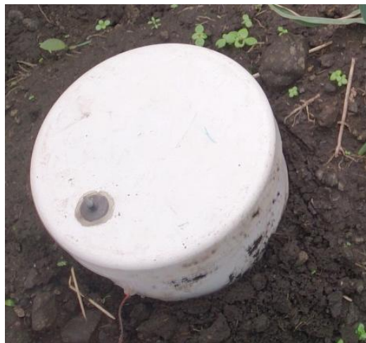
Fotografía 3. Cámara estática diseñada para muestreo de gases (Torres, 2014)
