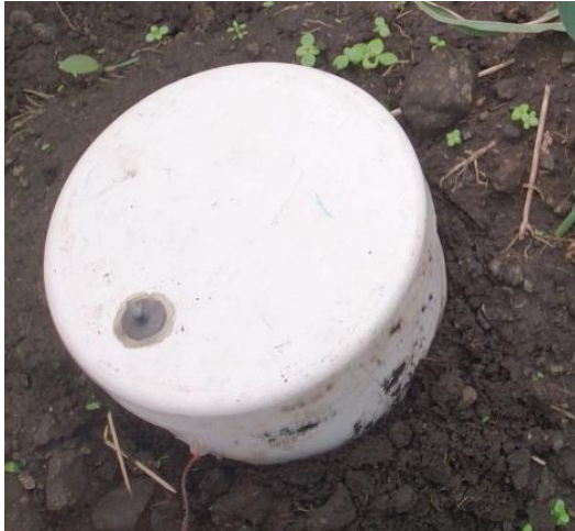
Fotografía 3. Cámara estática diseñada para muestreo de gases (Torres, 2014)
