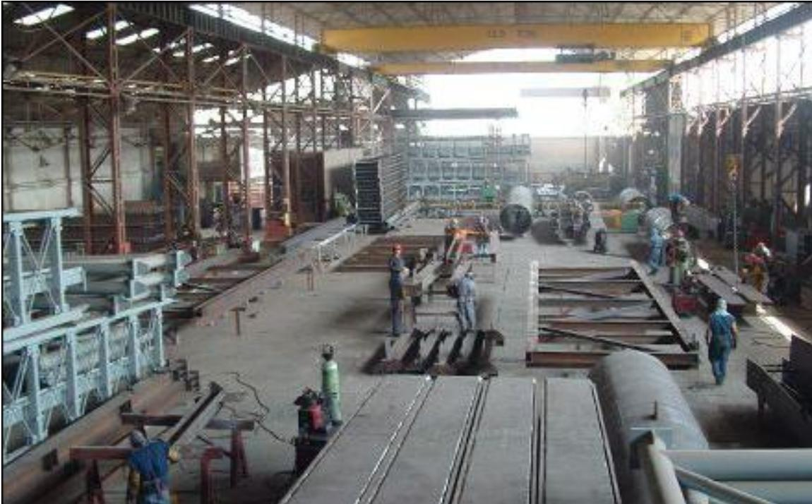
Figura 1.29. Fabricación de elementos estructurales del sistema PARMS (SAC, 2006).
