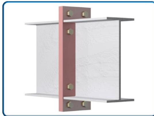
Figura 2.5. Conexión de placa de extremo para unir los cabezales de módulos adyacentes.
