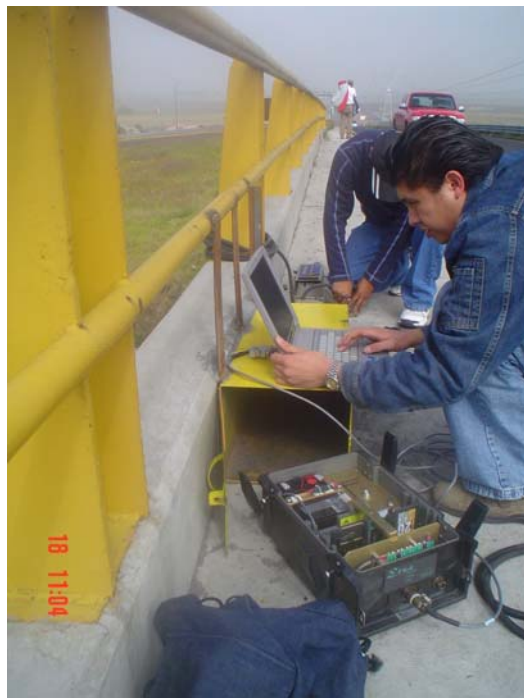
Figura 2.10. Colocación y puesta en operación del equipo de registro.
