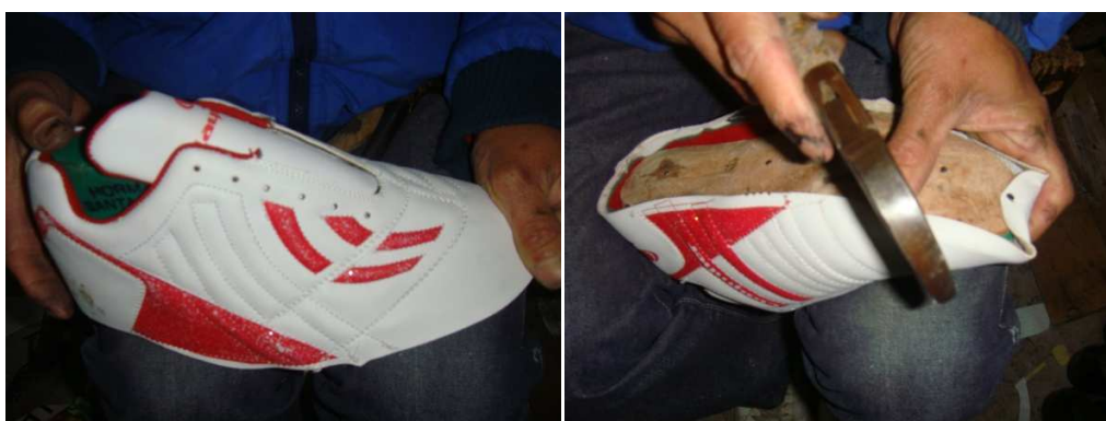
Fotografía 19 y 20: Montado del corte
