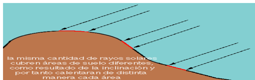
Imagen 4. Captación de rayos solares y sus diferencias según la inclinación en la ladera
