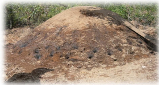
Imagen 25. Horno donde se elabora el carbón vegetal.
