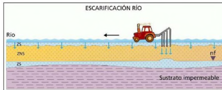
Figura 2.15 Escarificación del lecho del río (Fernández, et al , 2010).
