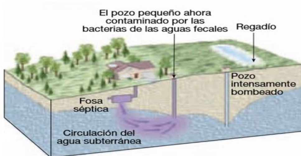
Figura 2.6. Contaminación del agua subterránea por aguas fecales (Tarbuck y Lutgens, 2005).
