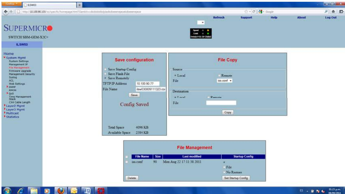
Ilustración 34. Respaldo de configuración en equipo externo
