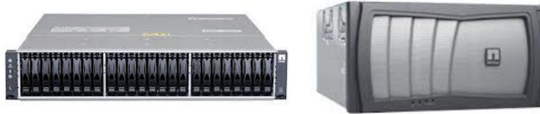
Ilustración 6. Controladora de NetApp y caja de discos
