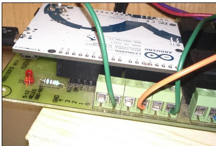
**ILUSTRACIÓN 25. IDENTIFICACIÓN DE LOS PINES QUE RECIÉN LOS DATOS DEL SENSOR DE FLUJO**
