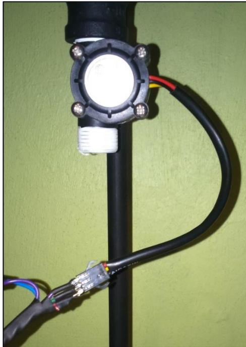
**ILUSTRACIÓN 24. CONEXIÓN CON HEADERS AL SENSOR DE FLUJO**
