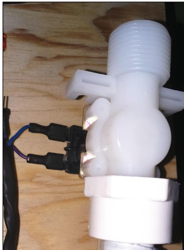
**ILUSTRACIÓN 22.CONEXIÓN DE LAS TERMINALES CON LA ELECTROVÁLVULA**
