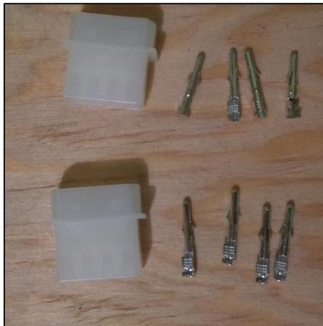
ILUSTRACIÓN 18.CONECTOR MOLEX MACHO SIN ENSAMBLAR
