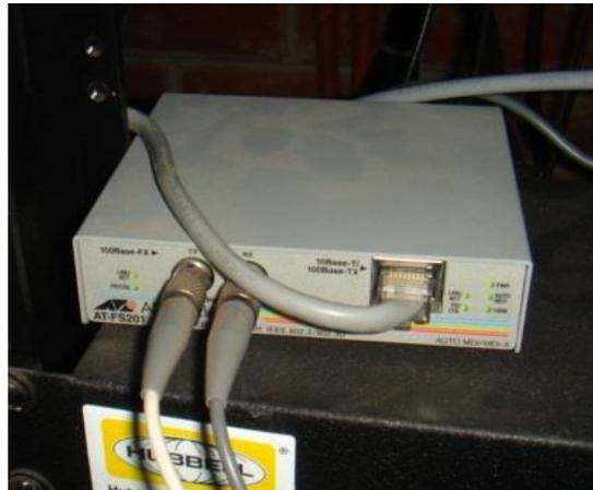
Figura 3.7 Convertidor Fibra Óptica Ethernet
