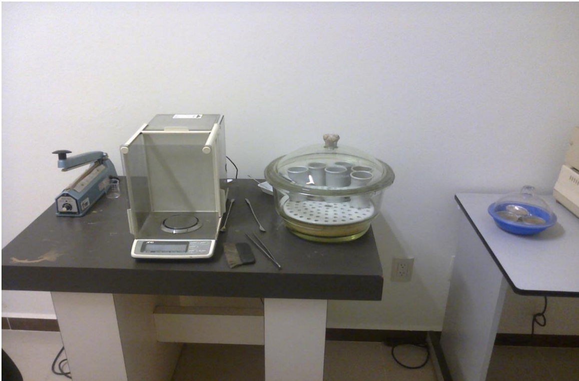
Figura 18. Pesado de muestras para determinar FDA, FDN, (fibras)
