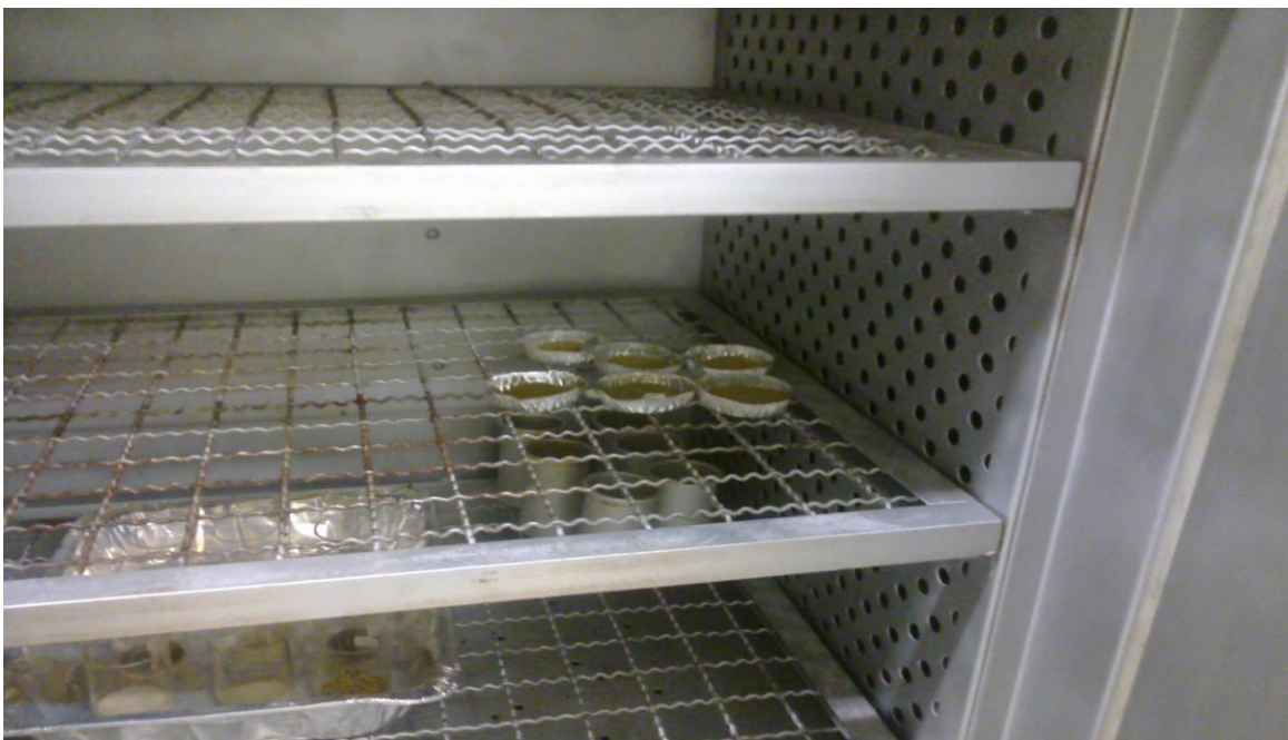
Figura 19. Secado de muestras para determinar FDA, FDN (fibras)
