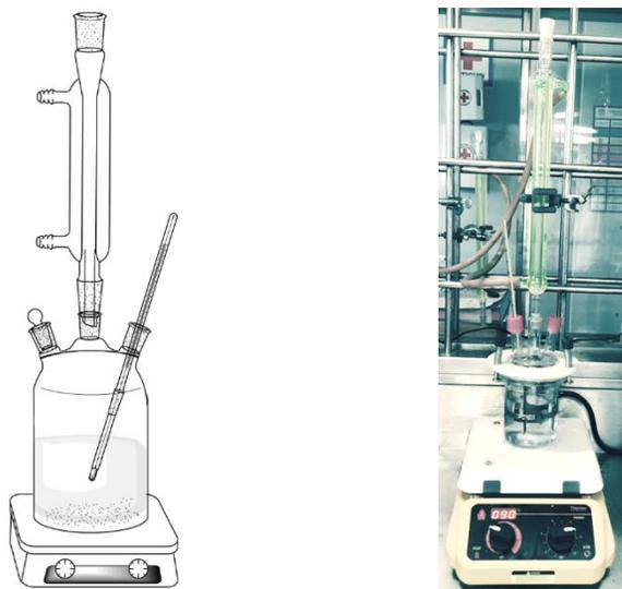
Figura 14. Reactor de vidrio de tanque agitado de 250 mL.
