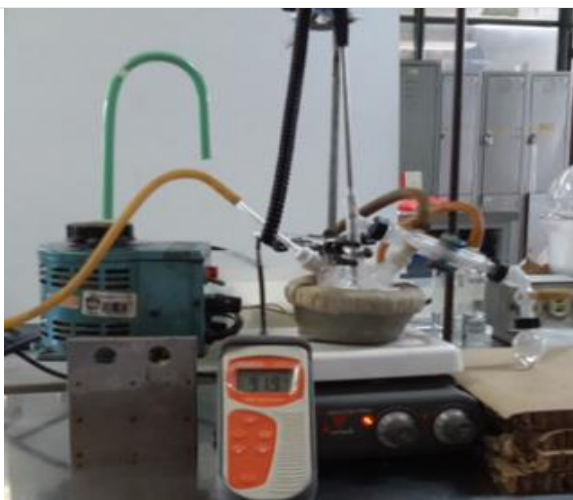
Figura 20: Dispositivo para llevar a cabo la reacción de esterificación de pentaeritritol
