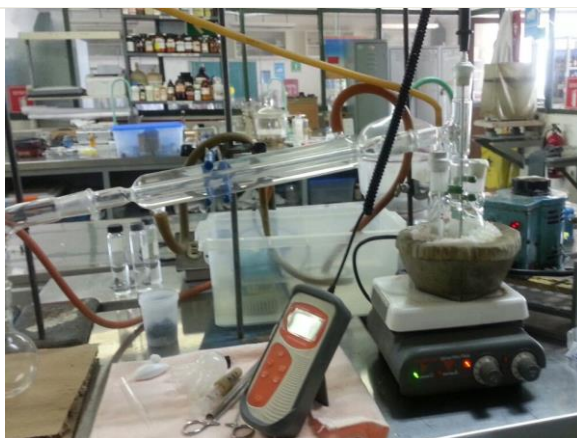
Figura 21: Dispositivo para llevar a cabo la reacción de funcionalización con poli etilenglicol
