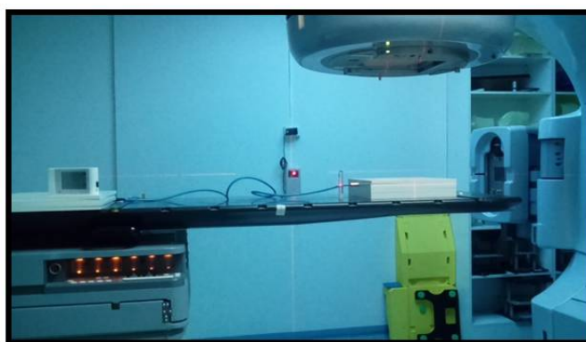
FIGURA 3.8: Sistema de medición compuesto de las placas de agua sólida y la cámara de ionización semiflex
