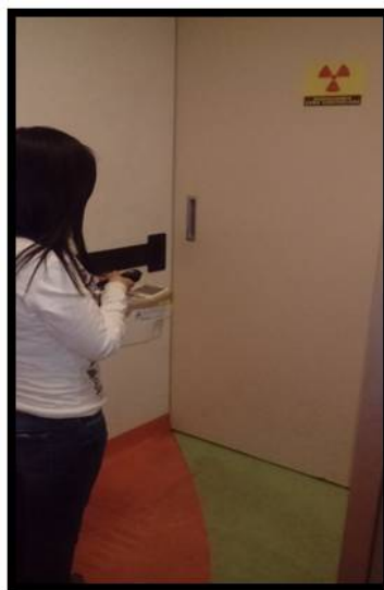
FIGURA 3.12: Medición a distancia de la radiación, fuera de la sala de tratamiento, utilizando el contador Geiger-Muller
