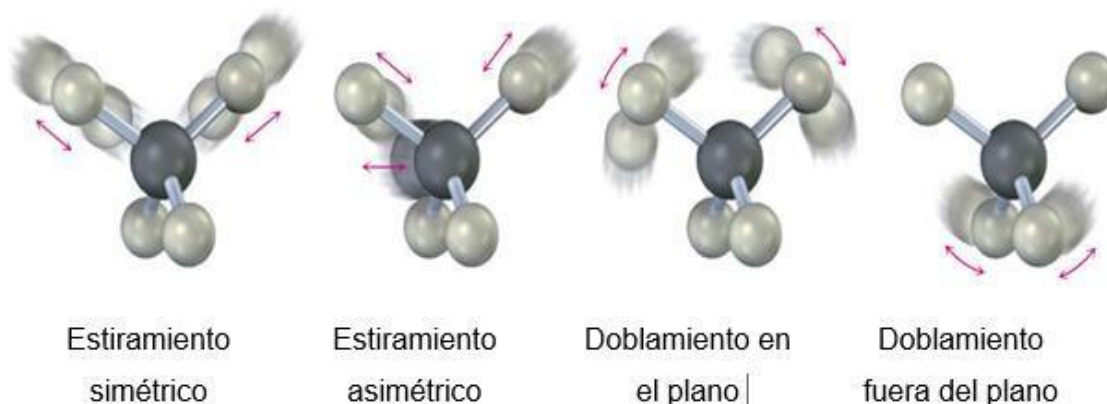
Figura 10: Movimiento de enlaces al incidir luz infrarroja sobre las moléculas.
