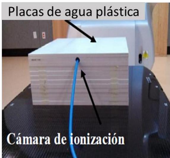
Figura 3.1. Esquema que muestra cómo fue irradiada la cámara de ionización a la profundidad de referencia.
