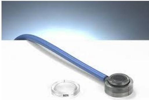
Figura 1.6 Cámara de ionización plano-paralela [14].
