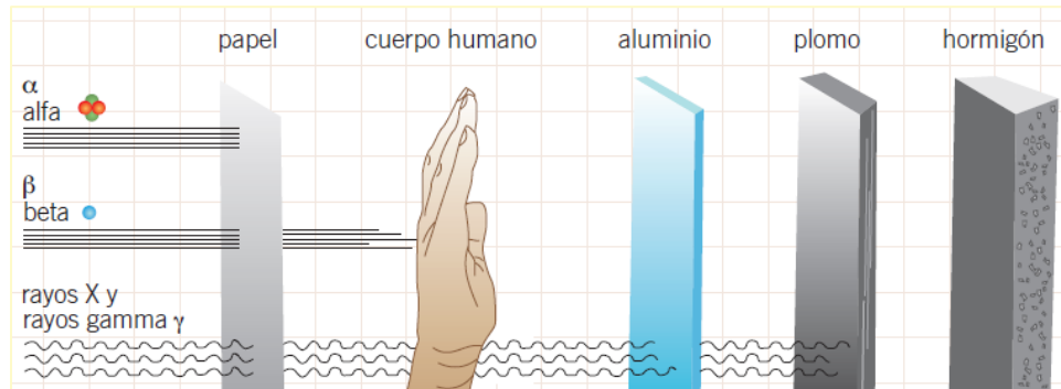
Figura 1.12 Capacidad de penetración de las partículas alfa, beta y de la emisión gamma. Fuente: CSN, 2010.
