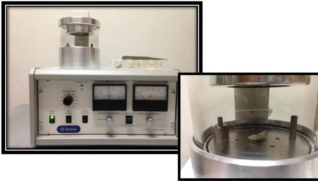
**Figura 16.** Máquina SC7620 Mini Sputter Coater. Quórum Technologies Ltd. Company. Kent Reino Unido utilizada para el recubrimiento con oro de las muestras.
