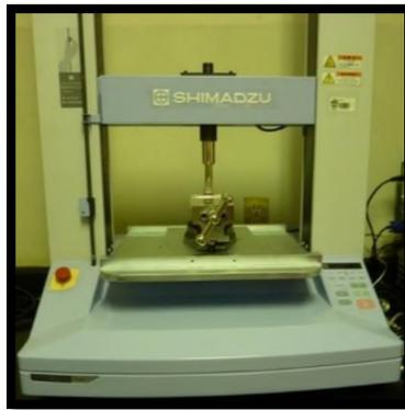
**Figura 22.** Máquina de ensayos universal (Autograph AGS-X, Shimadzu Co., Tokio, Japón).
