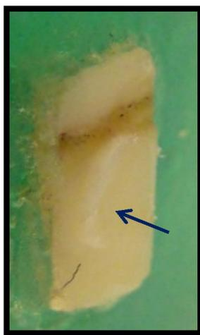
**Figura 24.** Imagen representativa de una de las muestras donde se observa el índice de Adhesivo Remanente (ARI).
