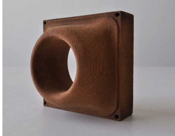
Figura 2.25. Bloque de madera impresa en 3D, como material de construcción. La madera está hecha de residuos agrícolas reciclados. Creado por Anthony Giannini. (Fuente: Bryden, 2014: 131).
