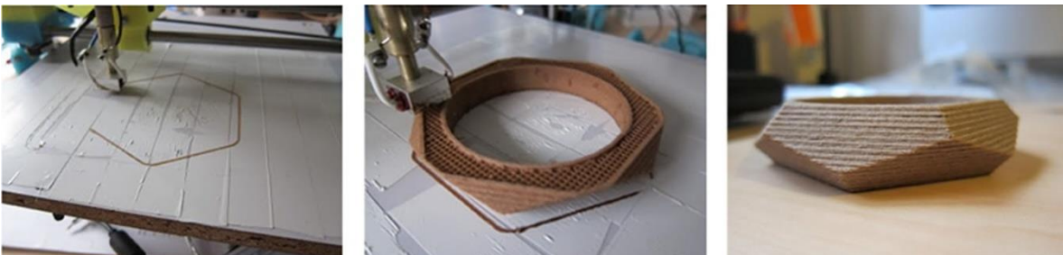
Figura 2.39. Impresora 3D, material de impresión de madera con resina. (Fuente: http://proyectolleona.blogspot.mx/search?updated-min=2012-12-31T15:00:00-08:00&updated-max=2013-06-22T15:31:00%2B02:00&max-results=3&start=3&by-date=false , consultado el 26 de junio de 2013).
