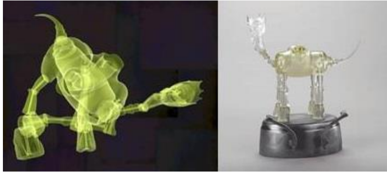
Figura 2.32. Títulada All fall down, primera imagen dibujo computalizado rendereado, segunda objeto de prototipo rápido en estereolitografía material Époxico. (Fuente: http://un-tethered.net/eevege/ , consultado el 8 de noviembre de 2013).
