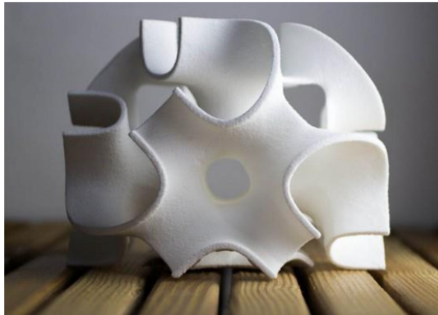
Figura 2.34. Pieza impresa en azúcar (Fuente: http://inhabitat.com/the-sugar-lab-uses-a-3d-printer-to-create-sweet-edible-geometric-sculptures/ , consultado el 16 de marzo de 2013).
