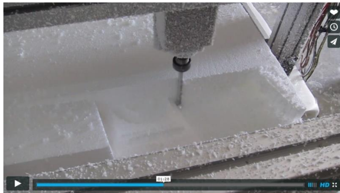
Figura 2.42. Título del video: CNC de corte y fresado de poliestiréno (Fuente: http://vimeo.com/52480287 , consultado el 23 de junio de 2013).
