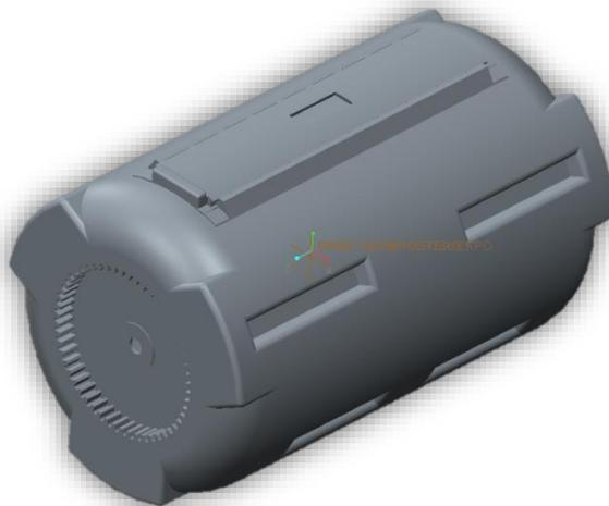
Figura 44 Componente a validar: cuerpo del reactor aerobio.
