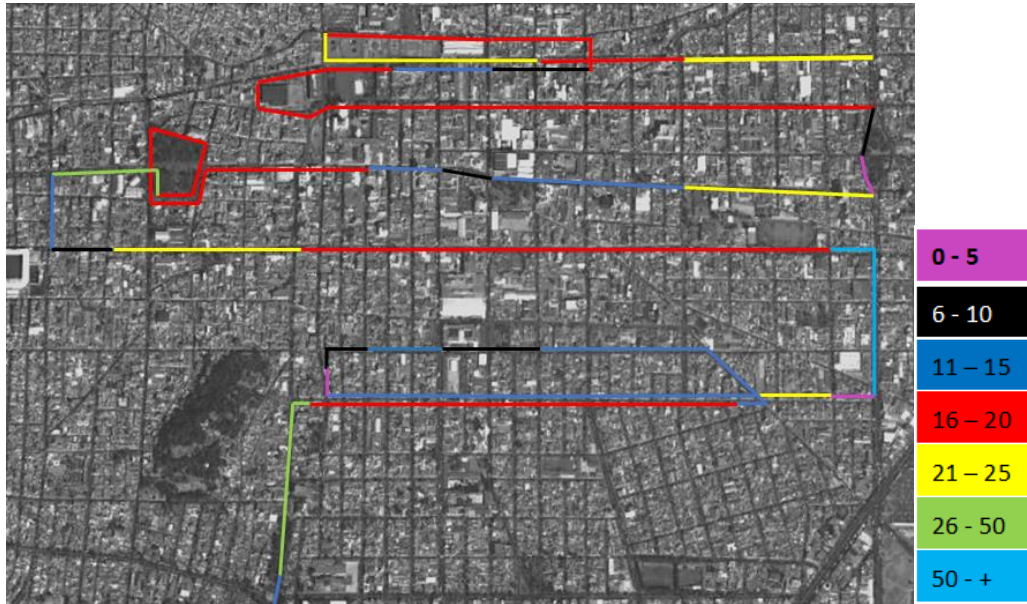
Fuente: Elaboración propia, mediante prospección. Figura 27. Velocidades de Vehículos en km/h en el CHT, ruta 2.
