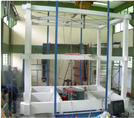
Figura 1. Modelo experimental del marco de CR [2].
