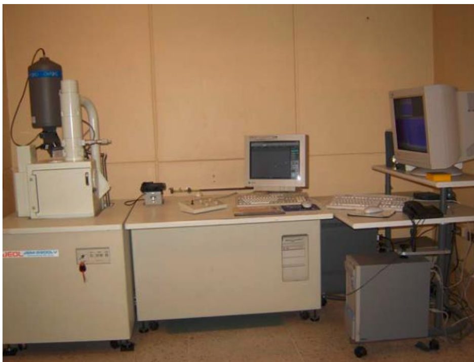
Figura 9. Imagen del microscopio electrónico de barrido, MEB. (CCIQS, UAEM-UNAM).
