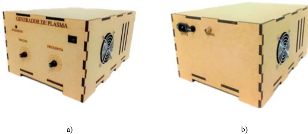
Figura 2.22 Gabinete físico del generador de plasma a) vista delantera, b) vista trasera.
