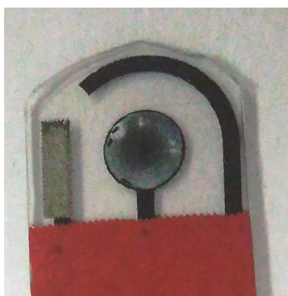
Figura A1.2 Formación de la membrana en la superficie del electrodo. Se observa de coloración blanquizca debido a la temperatura en que se encontraba, la cual se pierde al perder temperatura.
