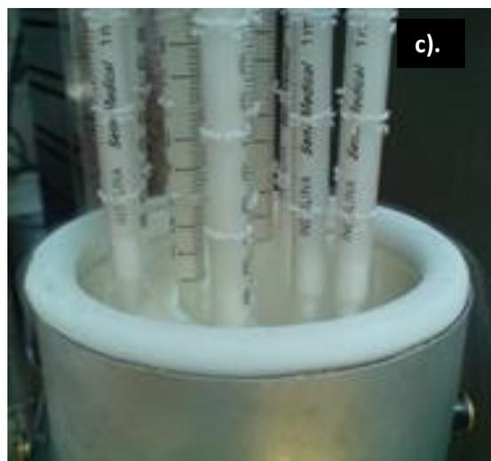
Figura 3. Síntesis de criogeles Q-C. a). Preparación de la geringa que contendrá el gel acuoso Q-C. b). Succión del gel acuoso Q-C. c). Inmersión en un baño criogénico de nitrógeno líquido (-196 °C).
