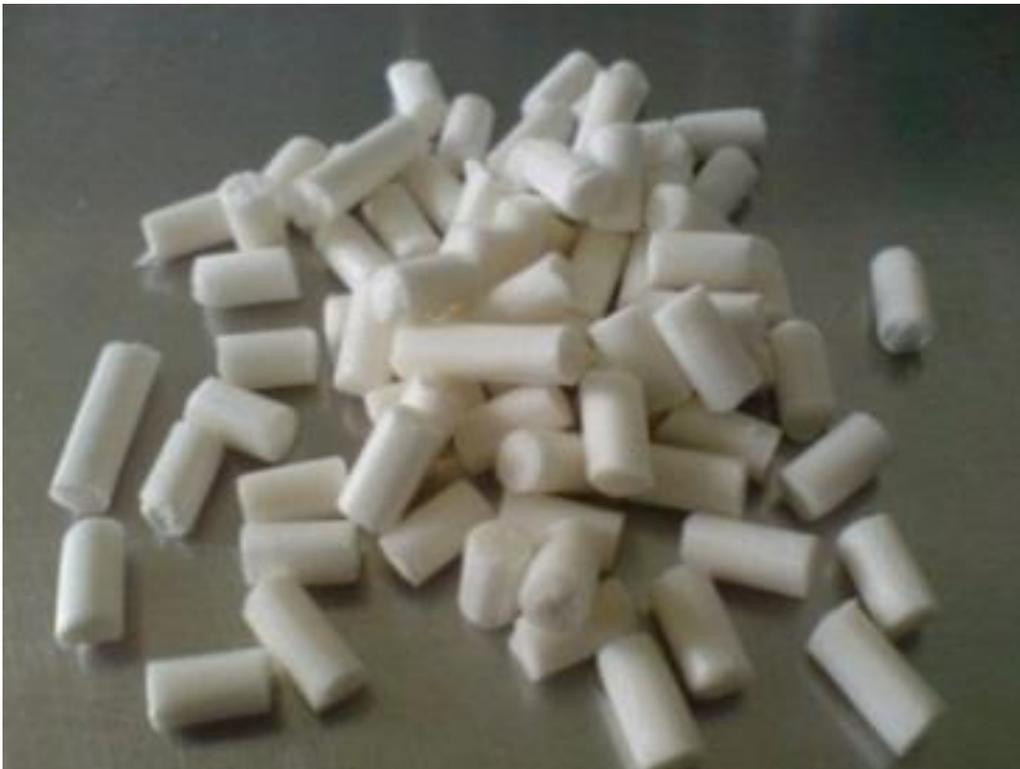
Figura 4. Criogeles Q-C obtenidos a partir de quitosano y celulosa después de un proceso de auto ensamblado inducido por segregación de hielo.
