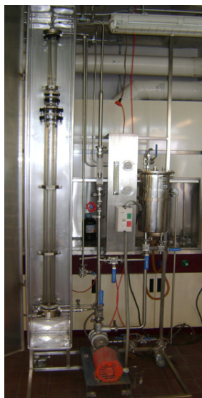
FIGURA 2. Columna de burbujeo: reactor fotocatalítico y/o electroquímico.
