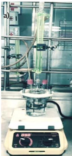
FIGURA 3. a) Reactor STR con condensador para la producción de biodiesel mediante la transesterificación de aceites vegetales catalizada heterogéneamente; b) fotorreactor STR para la evaluación catalítica de fotocatalizadores.
