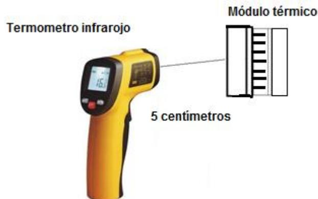
Fig. 56 Medición de temperatura en los módulos térmicos.
