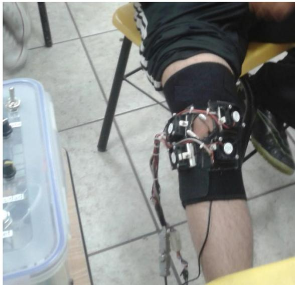
Fig. 62 Rodillera con módulos térmicos colocada sobre la persona
