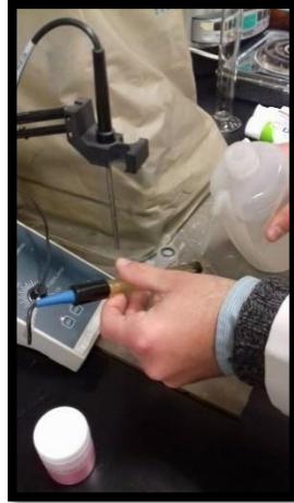
Figura 5. Lavado del electrodo con piseta de agua destilada.
