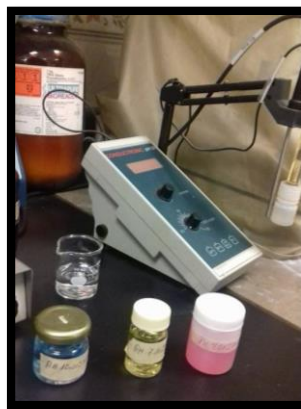
Figura 2. Imagen representativa del procedimiento para la calibración del Potenciómetro.
