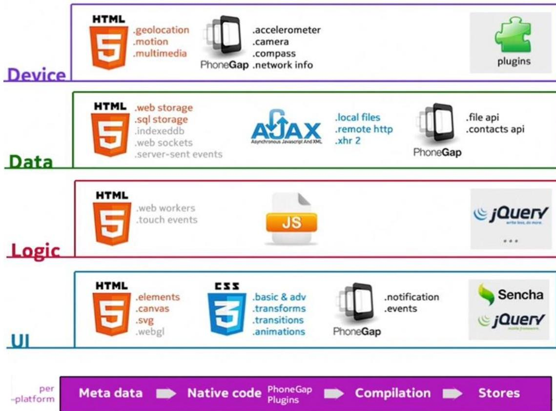
Ilustración 5. Arquitectura de una aplicación híbrida en PhoneGap. Fuente: Curso iOS y Android con PhoneGap y jQuery. Maximiliano Firtman
