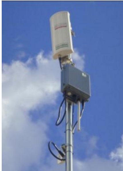
Figura 20. Antena de alto poder de alcance, ( http://web.frm.utn.edu.ar/comunicaciones/antenas.html ).
