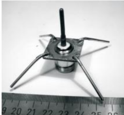
Figura 6. Antena de un cuarto de longitud de onda con plano de tierra, ( http://www2.uacj.mx/IIT/IEC/Digitales/ ).
