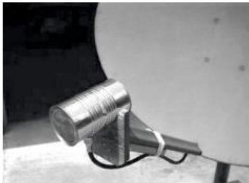
Figura 14. Antena bocina hecha con una lata de comida, ( http://es.slideshare.net/ErickPereiraPolo/teoria-de-antenas/2013 ).
