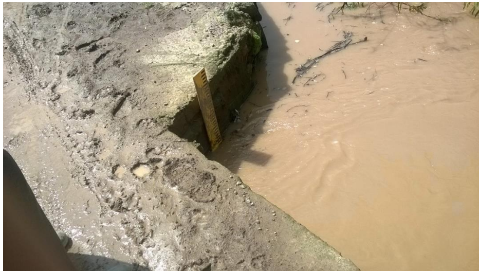
Figura 7.12. Observación de la escala limnimétrica del río.
