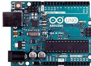
Figura.8.6.1 Placa de programación arduino UNO
