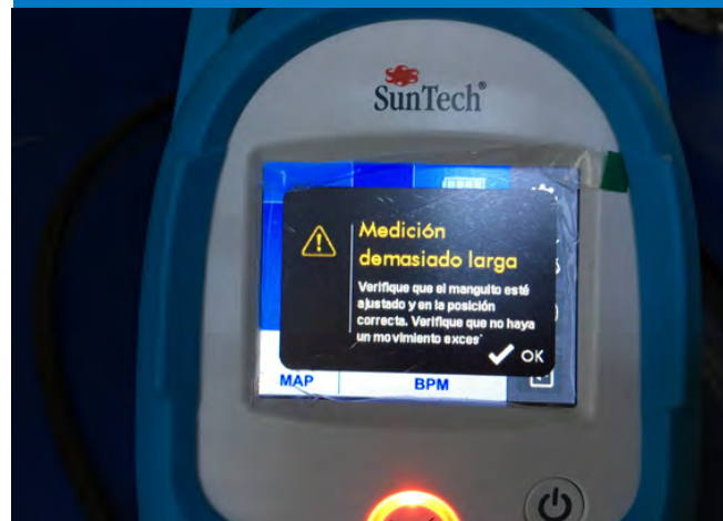
Figura 6. Los monitores oscilométricos actuales cuentan con alarmas que indican error en la medición, en vez de dar lecturas que pueden ser erróneas, lo que facilita las mediciones de la PA confiables.
