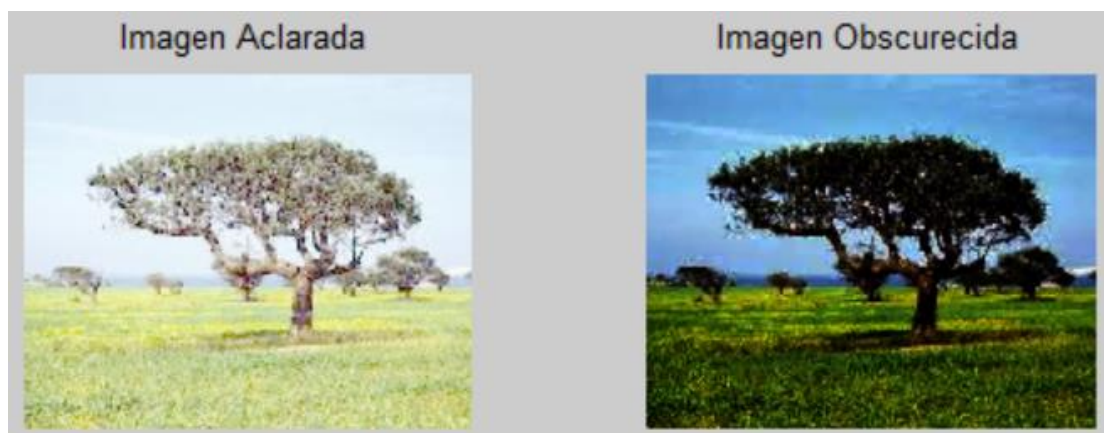
Figura 4-7 Transformación gamma aplicada para aclarar y oscurecer la imagen.
