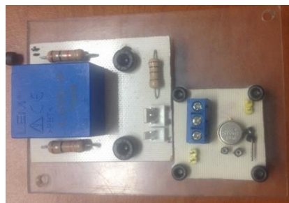
Figura 3.10. Fotografía de circuito impreso para transductor LEM LV25-P y sensor AD536AJHZ.
