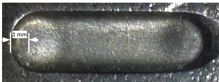
Figura 6.6: Resultado de prueba de maquinado lineal.
