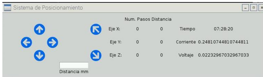
Figura 5.17: Versión 2 de la interfaz gráfica del proceso de maquinado electroquímico.
