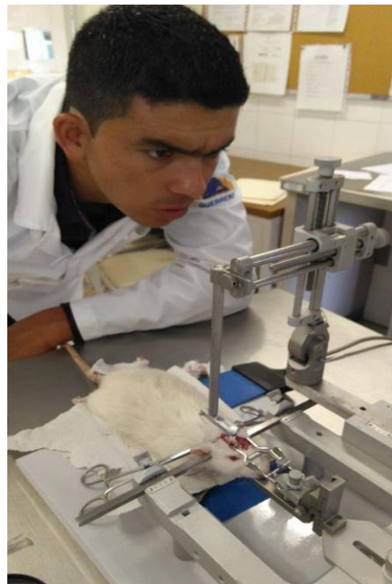
Imagen 6.- Lectura de coordenadas (-3.2 mm antero-posterior, +/- 3.2 mm lateral y -5.5 mm ventral a partir de “Bregma” según Paxinos et al. 2004).
