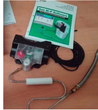
Figura 1.0 Sistema de medición de gases contaminantes a) Escáner Automotriz Genesys NGIS b) Modulo de Analisis de Gases M-P.
