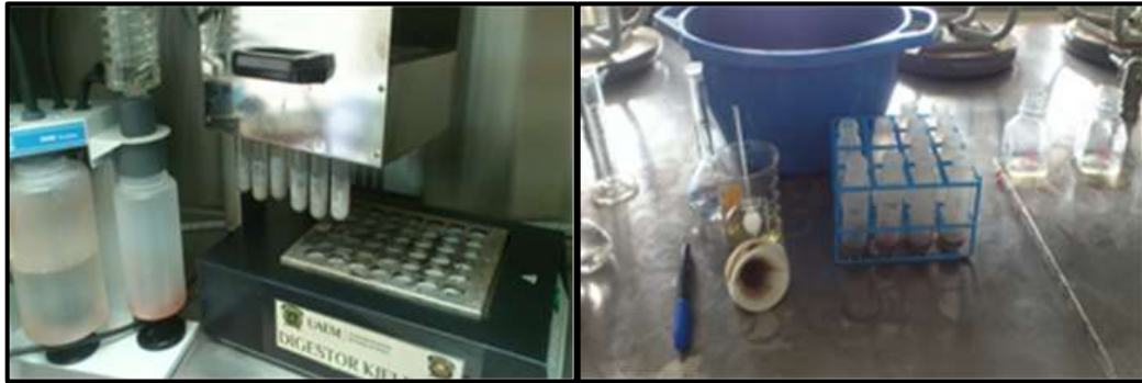
Imagen 1. Determinación de las propiedades químicas del suelo y de los abonos orgánicos.
