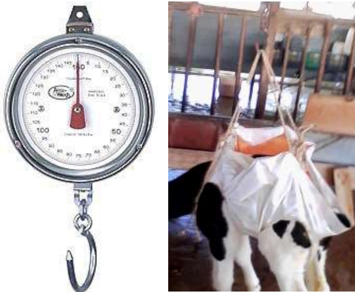
Figuras 4 y 5. Balanza de reloj y faja de lona.
