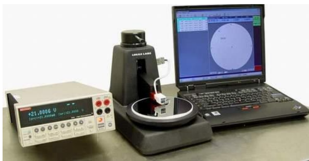
Figura 2. 6 Dispositivos para realizar el método de 4 puntas. Fuente, 4 puntas y software.
