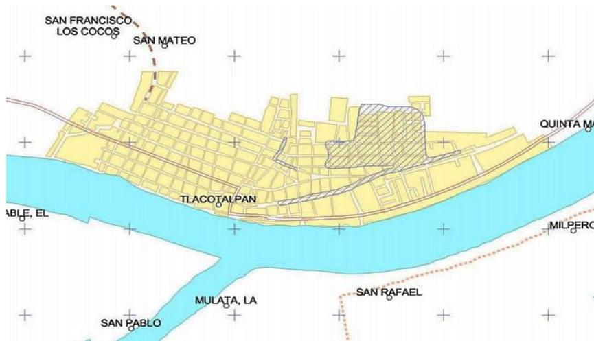
Ilustración 8. Áreas de inundación en la zona urbana por precipitación, por fallas en el drenaje.
