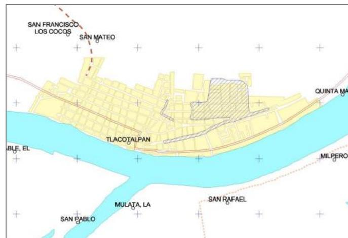
Ilustración 10. Áreas de inundación en la zona urbana por precipitación, debidas en gran parte a parte a fallas en el sistema de drenaje.
