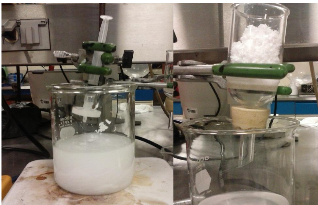
Figura 4.2 Esquema que muestra la etapa de purificación del 4-CIPS con metanol y el filtrado del mismo.
