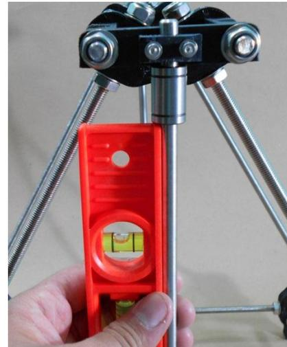
8. Colocar el eje X, previamente armado, verificando que el soporte de motor eje X esté del lado derecho del marco, cuidando que los rodamientos verticales queden dentro de los canales de los soportes.
