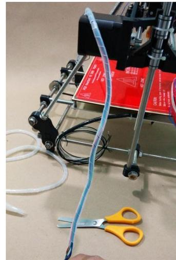
8. Ubicar la parte final del protector plástico cerca de la tuerca del vértice de pie izquierdo posterior y colocar un cintillo. Medir 150mm sobre la misma varilla y colocar otro cintillo.
