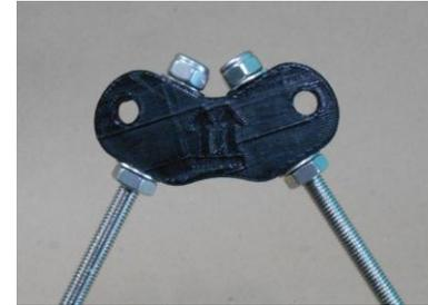
12. Antes de ajustar las tuercas de los vértices de marco, asegurarse con el separador de que las piezas de plástico estén a exactamente 290mm, moviendo las tuercas internas. Una vez realizado este paso, se procede a apretar las tuercas exteriores de seguridad hasta que el triángulo esté firme.
