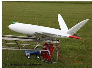
**2010.** Los ingenieros de la Universidad de Southampton diseñaron la primer aeronave impresa en impresora 3D, que se construyó en 7 días y una de las ventajas con la impresión 3D son las alas elípticas, una característica muy cara en fabricación convencional pero que mejoran la eficiencia aerodinámica y minimiza el arrastre.
