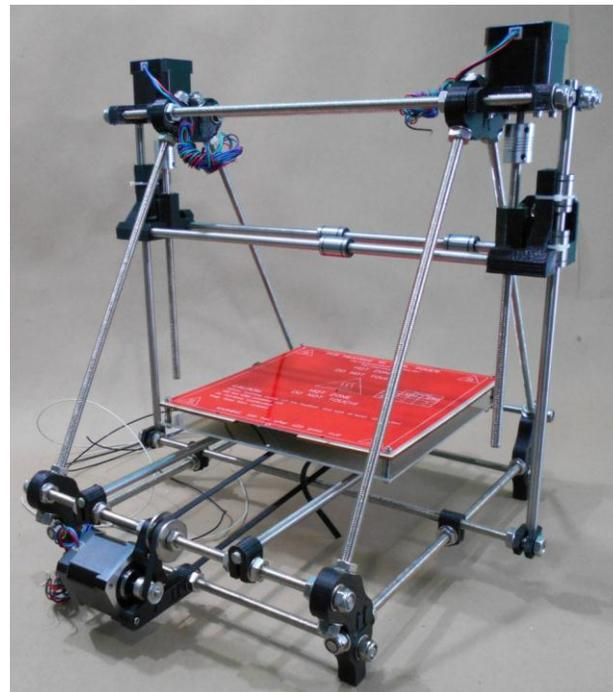
Con esto se termina el montaje de la cama de impresión (eje Y).
