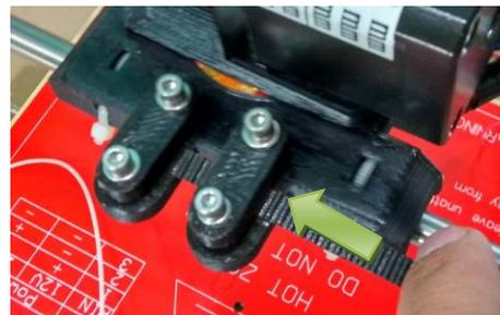
7. Pasar la banda por la polea izquierda y rodear con la misma el rodamiento que se encuentra en el soporte del lado derecho. Insertar el extremo sobrante en la abrazadera libre del carro del extrusor, aflojando primero los tornillos, tensado la banda para que quede firme y volviéndolos a apretar. Cortar el sobrante de la banda.
