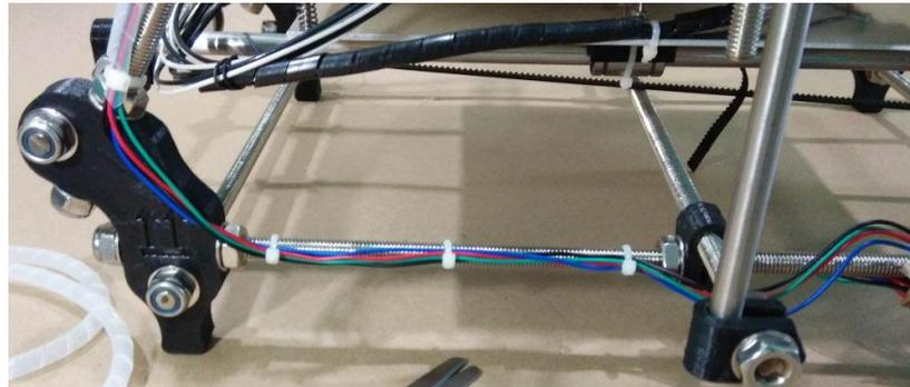
10. Desenrollar los cables del motor frontal y cubrirlos con 200mm de protector plástico, colocar un cintillo que sujete los cables protegidos entre el vértice de pie y la abrazadera de barra lisa frontal izquierda. Ubicar otro cintillo cerca de la tuerca lateral de la varilla inferior izquierda que sujete los cables del motor izquierdo y motores superiores.
