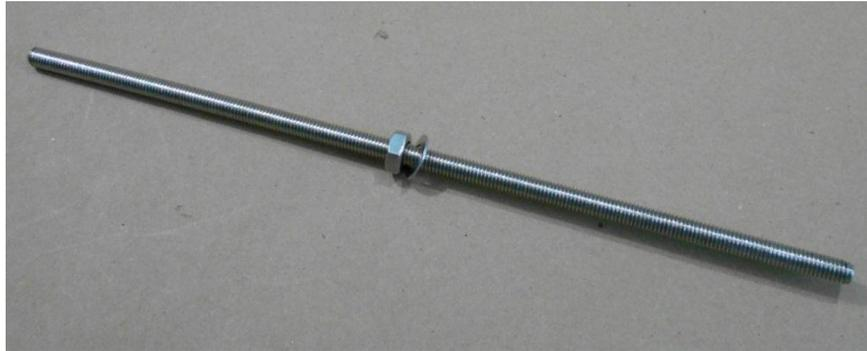
15. Insertar en la parte inferior del soporte de motor "Y" por la parte recta (ver imagen) hasta tocar la arandela.
