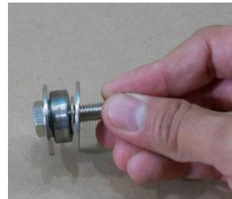
5. Colocar el tornillo en el orificio del soporte de eje X y ajustar con una tuerca M8 y una arandela M8.
