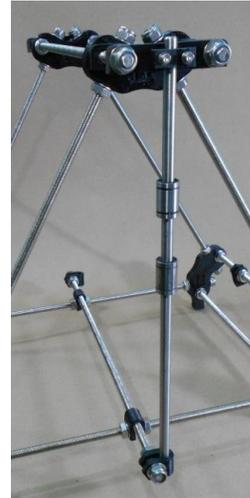
7. Con el nivel de torpedo, verificar frontal y lateralmente que se encuentren alineadas las varillas lisas, ajustando las tuercas de la varilla inferior.
