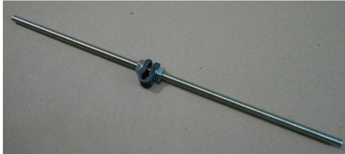
5. Enroscar otra tuerca de cada lado de la varilla a unos 50mm del extremo, seguida de una arandela.
