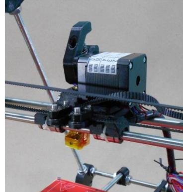
8. Verificar que el carro del extrusor se mueva libremente por el eje X (con un poco de resistencia debido al motor). La banda debe correr al centro de la polea izquierda y del rodamiento derecho, de no ser así ajustar la altura de la polea aflojando el tornillo prisionero.
