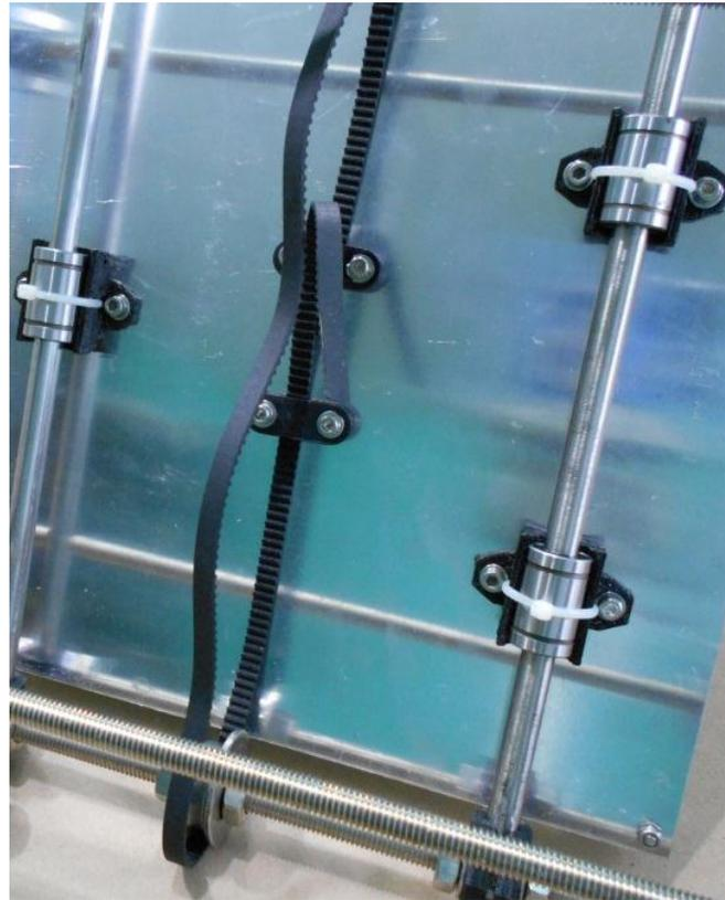
14. Mover lentamente la cama de impresión con la mano, ésta deberá moverse con un poco de resistencia, la banda no deberá curvarse y siempre correrá centrada en los rodamientos. De esta manera se verifica que esté bien colocada. Cortar el sobrante de la banda.
