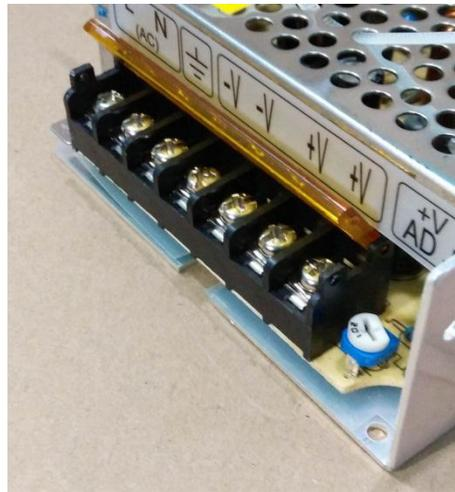
5. Descubrir las puntas de del cable AC con clavija a 15mm, enrollarlos y curvarlos. Desatornillar las terminales marcadas L y N (AC), colocar las terminales y atornillar de nuevo.
