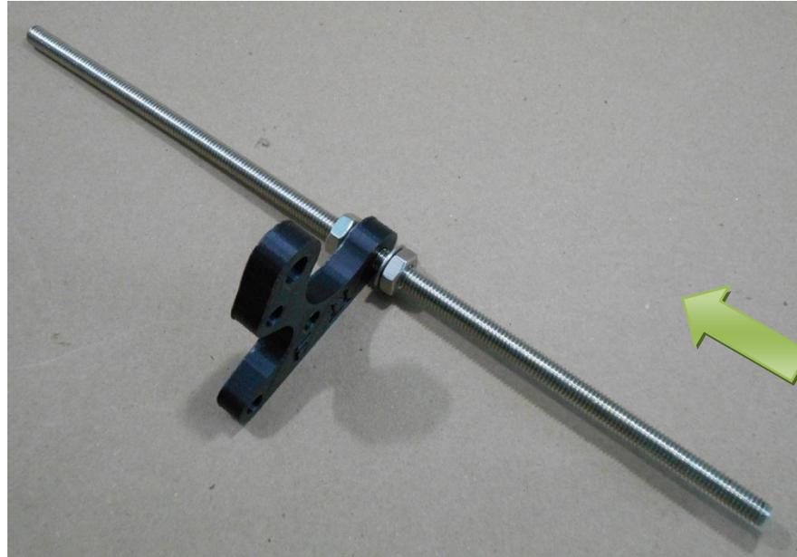
17. Enroscar una tuerca M8 a cada extremo de la varilla, aproximadamente a 25mm, seguido de una arandela por lado.
