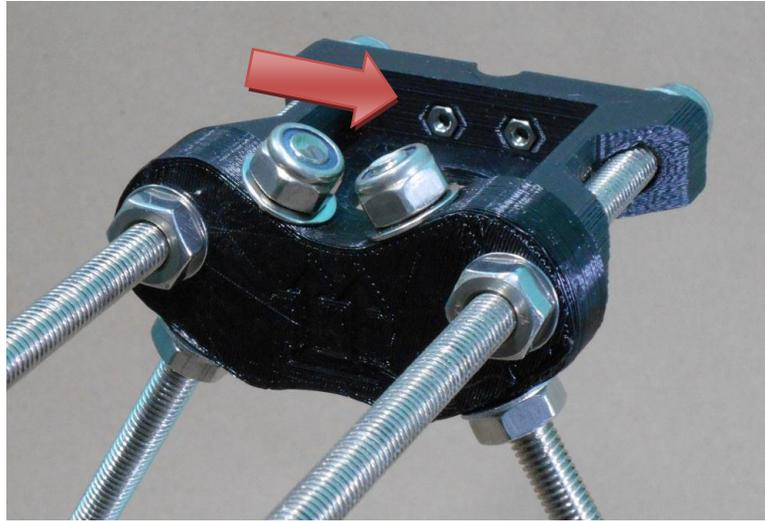
5. Insertar dos tornillos M3, con una rondana M3 de seguridad y una rondana M3 en cada uno, en la abrazadera de barra lisa y atornillarlos suavemente en el montaje de motor Z. (no apretar demasiado). Repetir el proceso en el otro montaje de motor Z.
