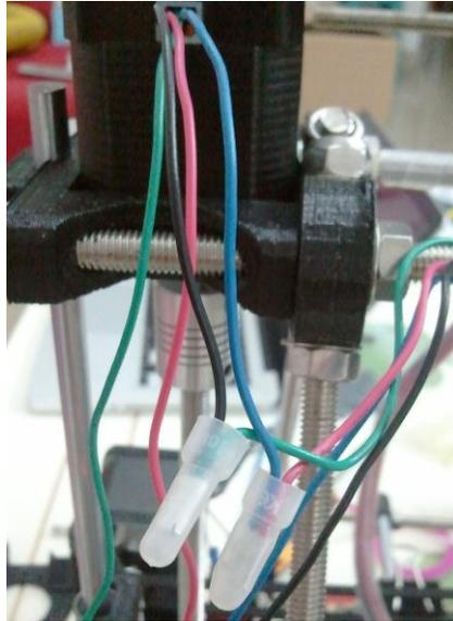
7. Desenrollar los cables del motor de eje X y cubrirlos con el protector plástico por 300mm, cortando el exceso.
