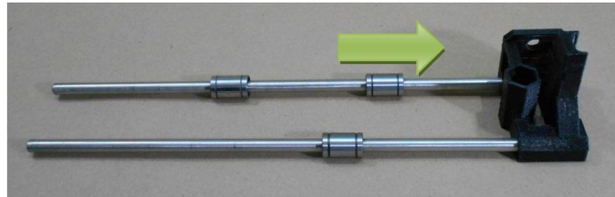
3. Insertar los extremos de las barras en los orificios del soporte de motor de eje X (marcado L) hasta el fondo. (verificar que las partes hexagonales de los soportes de eje y de motor estén de frente, una de la otra)
