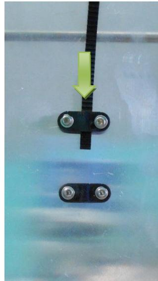
13. Posicionar la banda Y sobre los rodamientos del marco y la polea, cuidar que la banda no pase sobre las varillas inferiores del marco. Aflojar los tornillos de la abrazadera posterior de la cama de impresión, insertar el extremo sobrante de la banda, jalarlo hasta que ésta quede firme y ajustar los tornillos de nuevo con la llave Allen, de no quedar tensa aflojar la abrazadera, jalar nuevamente el extremo de la banda hasta tener la tensión deseada y volver a atornillar.
