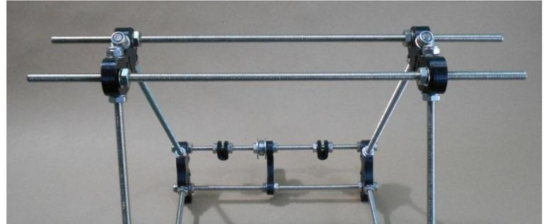
31. Insertar un montaje de motor Z en cada extremo de varilla, conservando la parte plana hacia abajo, seguido de una arandela M8 y una tuerca de seguridad M8.
