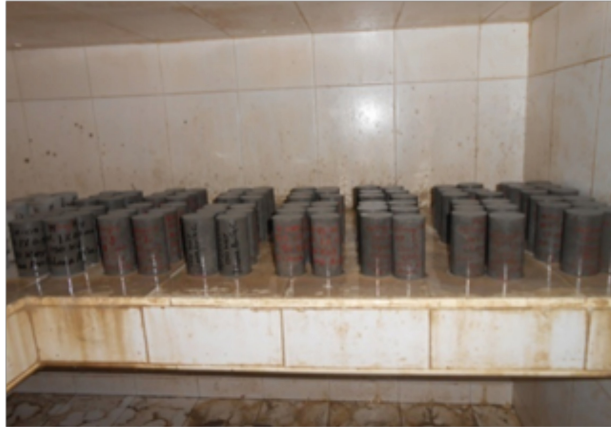
Figura 6. Proceso de curado durante 28 días de las probetas de concreto
